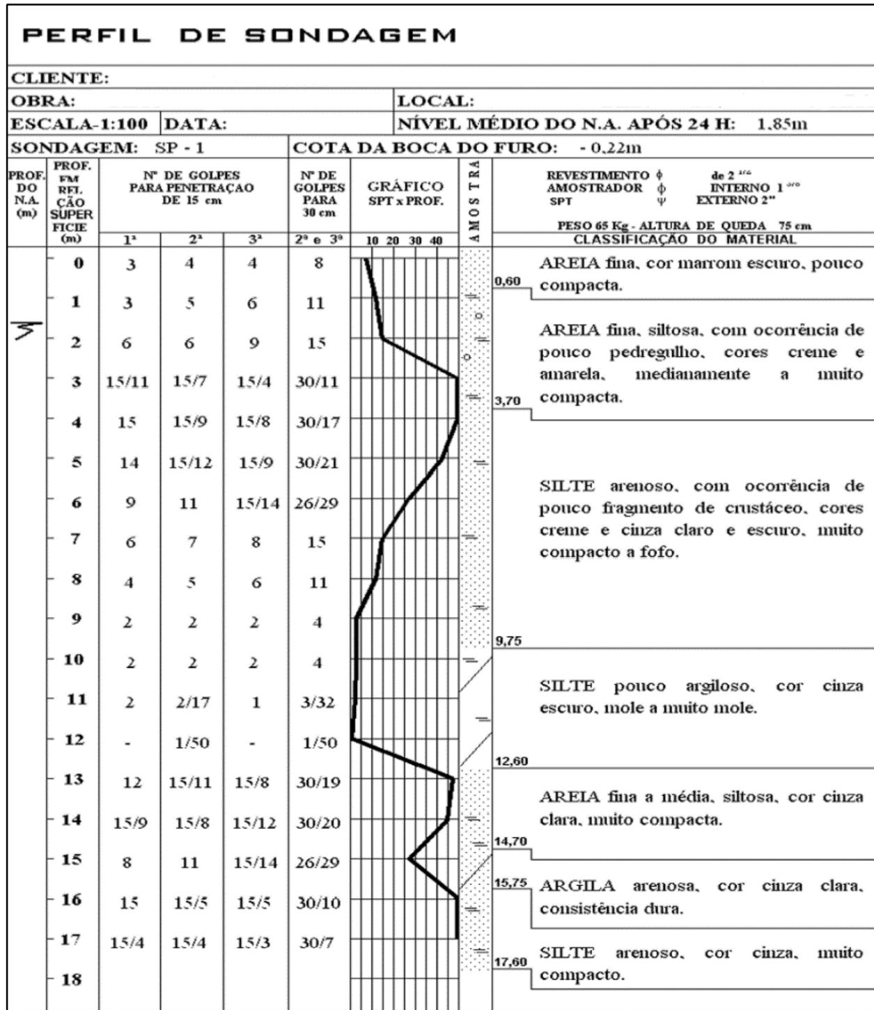
Figura: Perfil de sondagem de solo
